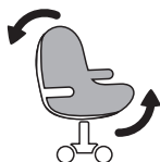
MÉCANISME SYNCHRONE : Le dossier et l'assise basculent ensemble et s'adaptent aux mouvements de la personne assise, de façon synchronisée et depuis un angle différent.
